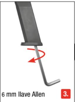
3. Gire hacia abajo el tornillo de perforación del cápsula.
