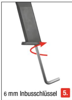
5. Kapselanstechschraube hochdrehen, CO<sub>2</sub>-Kapsel wird angestochen.
