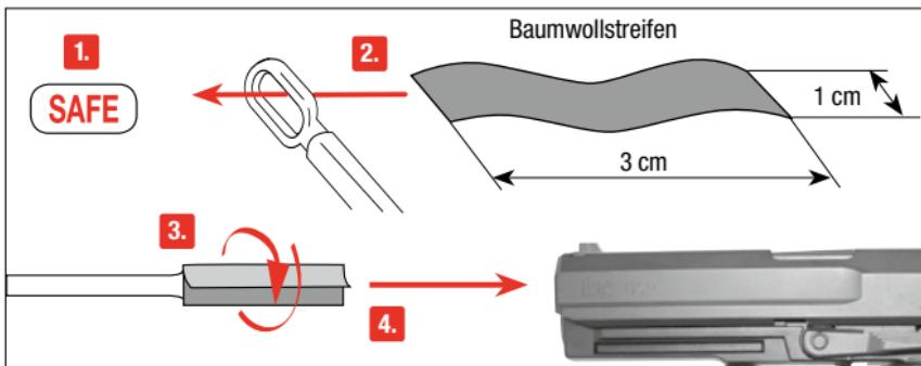
Sichern Sie die Waffe. Nehmen Sie einen ca. 30 cm dünnen, langen Stab. Wickeln Sie ein Stück Baumwolltuch um das Ende, benetzen Sie das Tuch mit etwas Waffen-Öl und reinigen Sie damit den Lauf.
