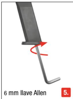
5. Gire el tornillo de perforación; se perforará el cápsula de CO<sub>2</sub>.
